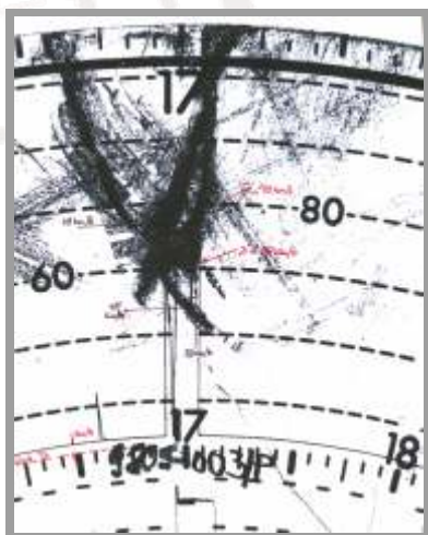
Rys. 23. Pomimo celowego uszkodzenia zapisu wypadku możliwe było odtworzenie parametrów ruchu pojazdu.
