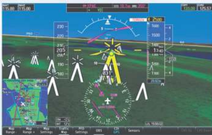
Zobrazowanie przeszkód-masztów w 3D przez system SVT na ekranie monitora PFD Garmin G1000.
