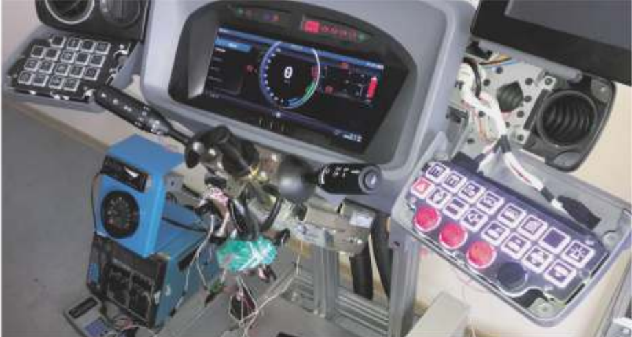
W śmieciarce elektrycznej BANKE, nasi inżynierowie z Departamentu Research & Development wykonali integrację całego pojazdu w obszarze niskoprądowym.
