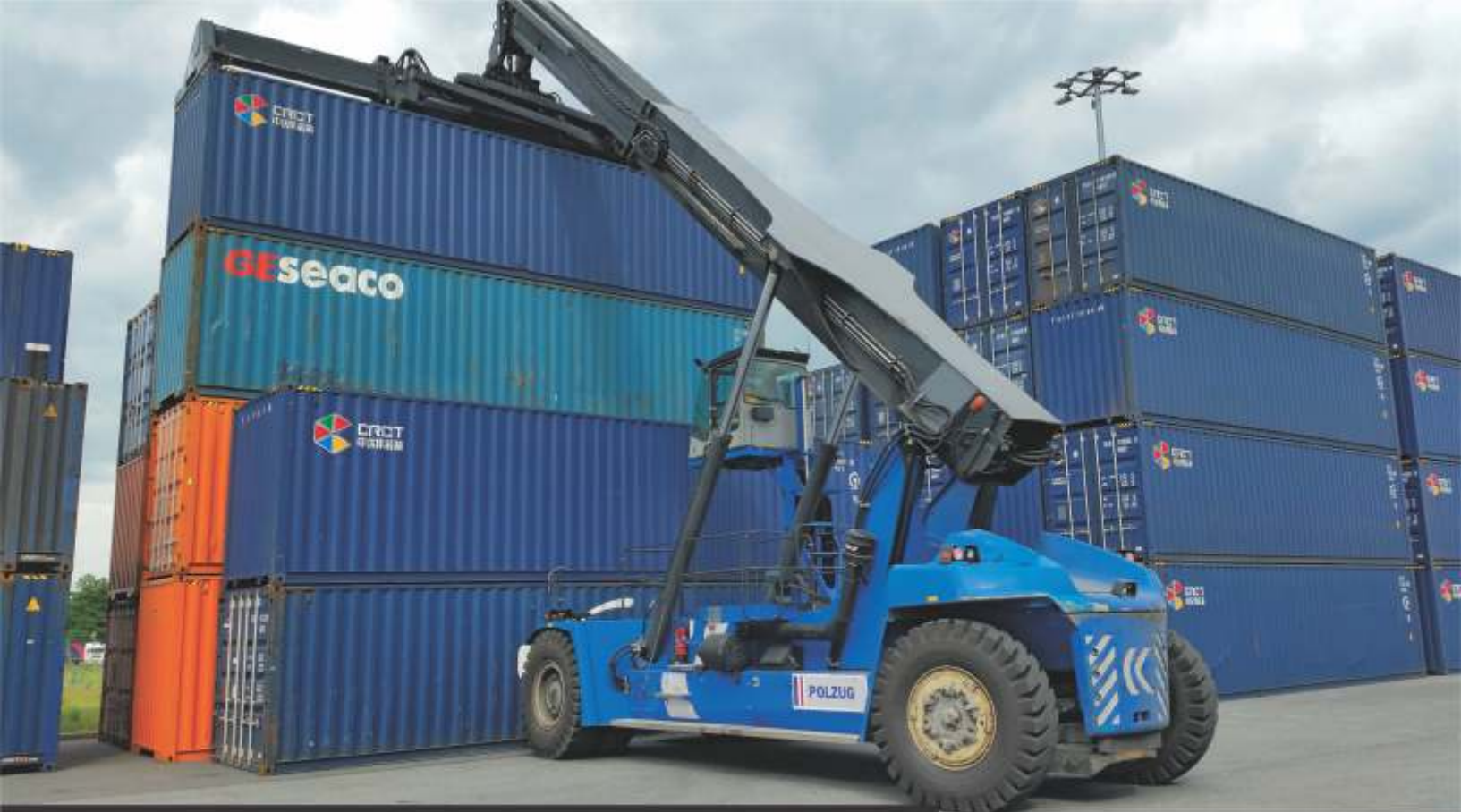
Reach Staker z systemem monitorowania ciśnienia i temperatury opon ContiPressureCheck
