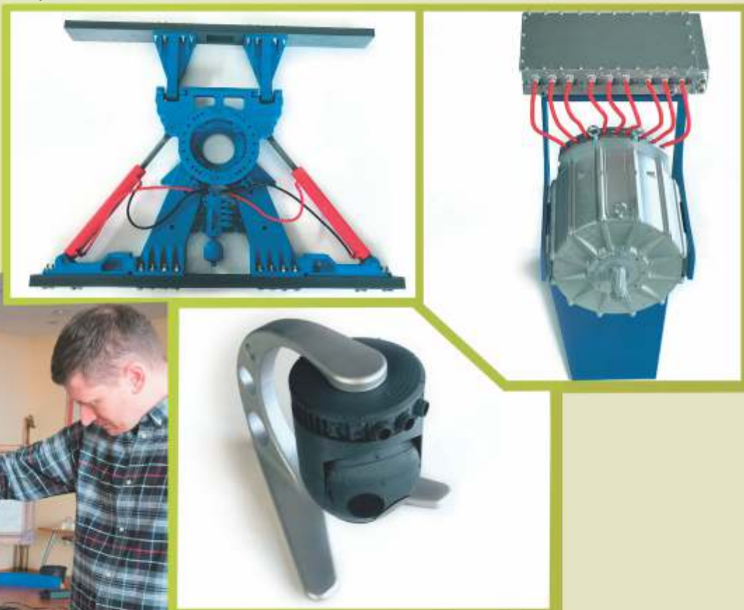
Makiety systemu przegubu ATG, silnika elektrycznego TM4 oraz systemu obserwacji lotniczej L3, wydrukowane na drukarce 3D dla naszych, wewnętrznych potrzeb.
