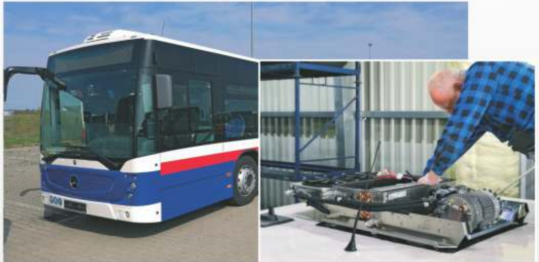
W 11. autobusach Mercedes Conecto 18 m. zamontowaliśmy klimatyzatory Konvekta KL20.
