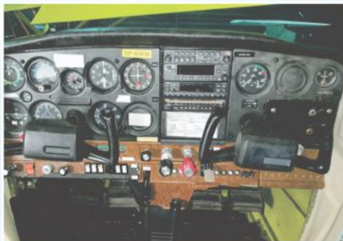
Nowe wyposażenie Cessny 152 - od góry – audio panel GMA 342 i radio GTR 225A
