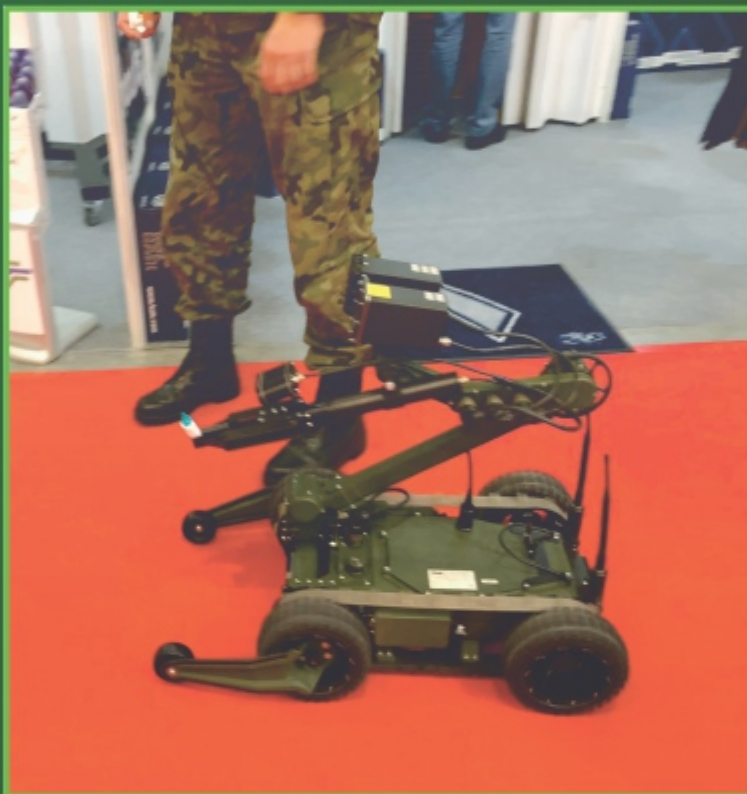
Lekki Robot Rozpoznawczy LRR „BALSA”, skonstruowany przez warszawski PIAP z akumulatorem litowo-jonowym typu BB2590 SMBus Denchi.
