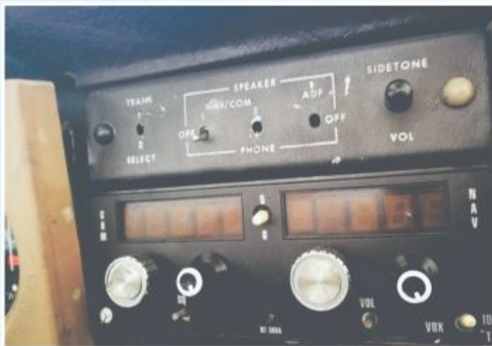
Jeden z samolotów Aeroklubu przed modyfikacją – na zdjęciu oryginalne wyposażenie Cessny - audio selektor i radio RT 385
