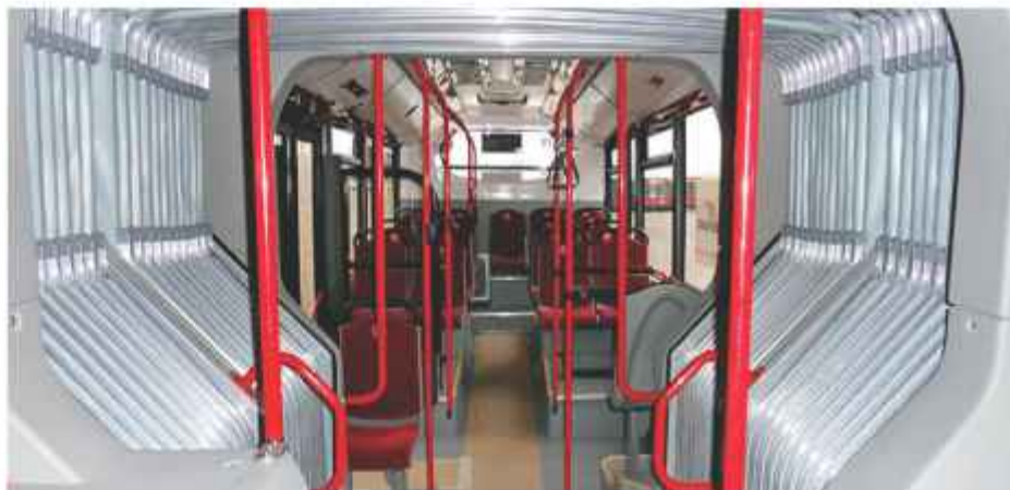
Opończa przegubu widziana z wnętrza pojazdu. W środku zostały zamontowane dodatkowe poręcze dla podróżnych.
