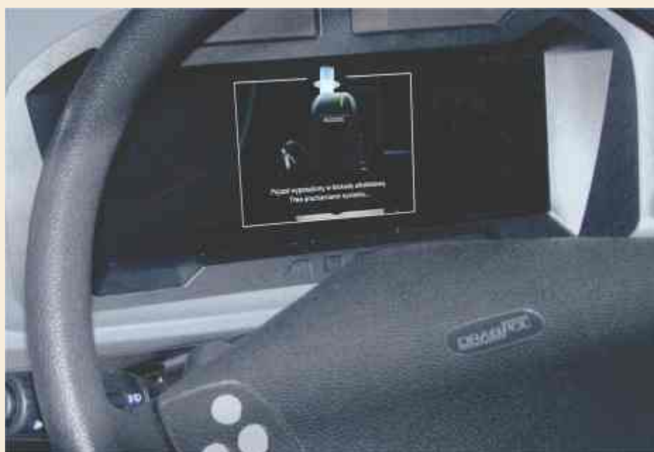
Kontrola wymuszana jest po każdorazowym wyłączeniu i załączeniu stacyjki autobusu.
