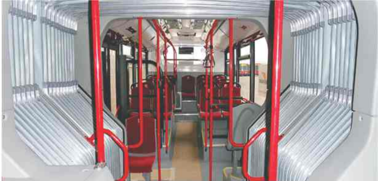
Opończa przegubu widziana z wnętrza pojazdu. W środku zostały zamontowane dodatkowe poręcze dla podróżnych.
