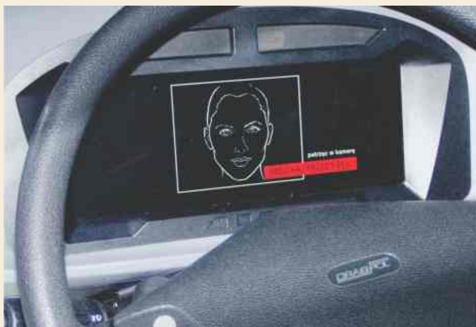
Dodatkowym zabezpieczeniem jest wymóg dopasowania się kierowcy do rysunku twarzy na ekranie, a w konsekwencji dokładny, filmowy zapis osoby, poddającej się testowi.
