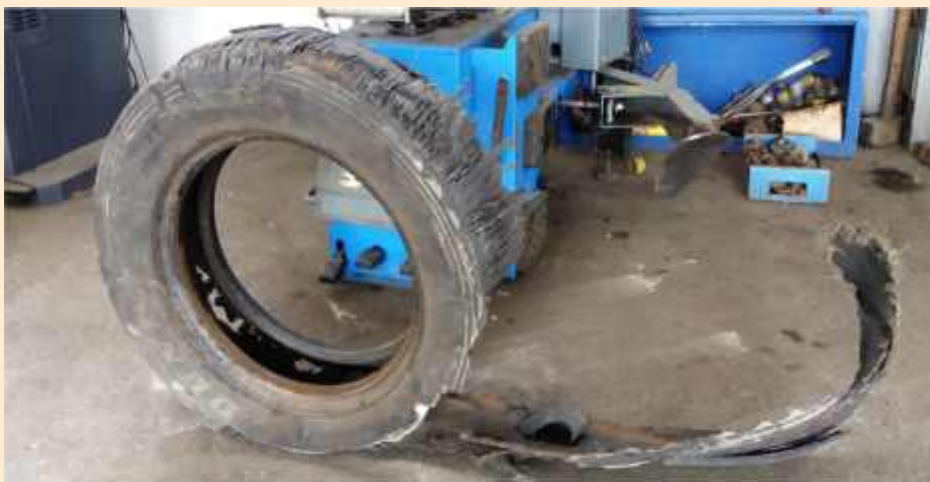
Zniszczona opona z rozwarstwieniem bieżnika od przyczepy do przewozu samochodów osobowych.
