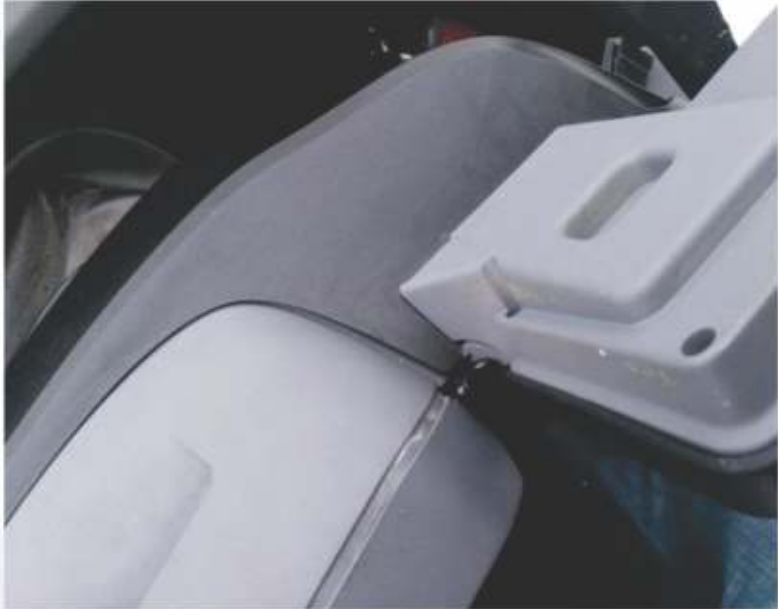
Podczas 58 cykli testowych, przeprowadzanych na trudnej nawierzchni nastąpiło pęknięcie prawej obudowy wyświetlacza.
