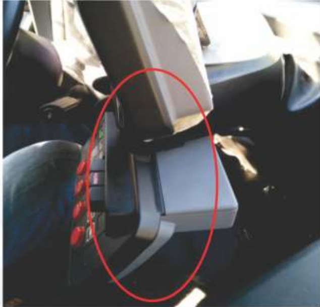
Podczas 58 cykli testowych, przeprowadzanych na trudnej nawierzchni nastąpiło pęknięcie prawej obudowy wyświetlacza.
