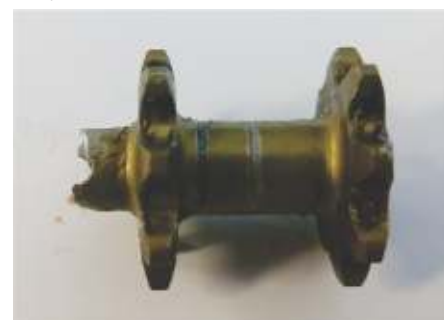
Urwany walek mechanizmu trymera wysokości, jako przykład siły, którą dysponuje serwomechanizm.
