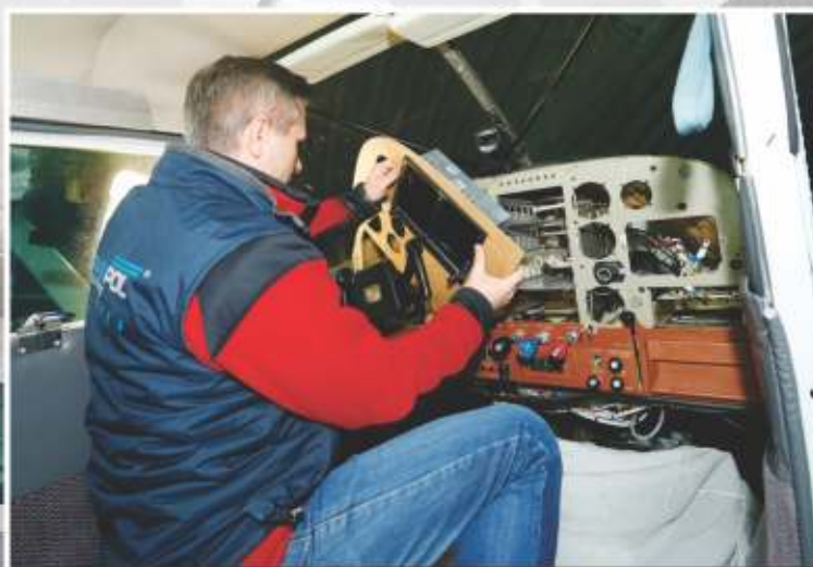
Montaż zintegrowanej awioniki glasscockpit G 500 firmy Garmin w naszym Centrum Obsługi Lotniczej w Modlinie.
