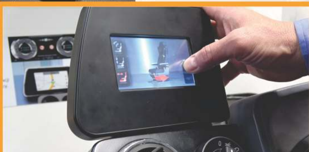
Na wyświetlaczu 4" MVF można było sterować fotelem, który posiada elektryczną regulację kąta nachylenia oparcia oraz kąta nachylenia siedziska
