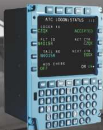
Honeywell CD-820 – starszy model kontrolera i wyświetlacza FMS
