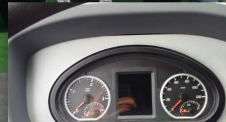
Firma Autobox w jednej z wojskowych ciężarówek STAR zastosowała sprawdzony wyświetlacz Flex Cluster.
