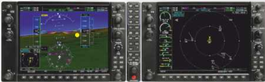
Na wyświetlaczu piloci mogą zobaczyć m.in. darmową subskrypcję danych pogodowych oraz obiekty ruchu ADS-B.
