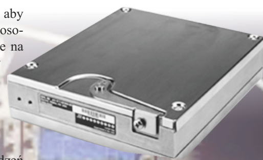
Garmin GDL-88 UAT ADS-B Out montowany zdalnie na statku powietrznym do współpracy m.in. ze zintegrowaną awioniką G1000 czy G500/600.
