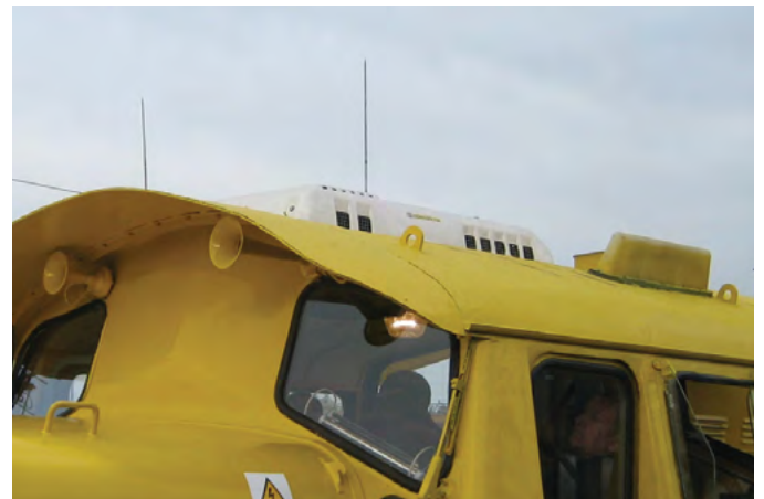
Na zmodernizowanej przez firmę NEWAG lokomotywie zastosowano klimatyzator miejsca pracy motorniczego.
