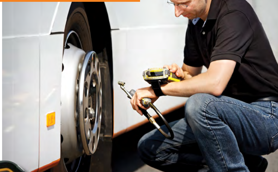
Przenośny komputer Continental skraca zdecydowanie czas kontroli ciśnienia i temperatury w kołach, zapewniając przy tym dużą wygodę.
