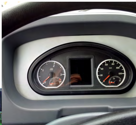
Wyświetlacz FlexCluster prezentuje wszystkie informacje niezbędne do kontroli funkcji pojazdu.
