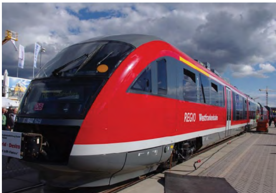
W pociągu Westfrankenbahn zastosowano rozwiązanie, polegające na połączeniu napędu hybrydowego z systemem klimatyzacji CO 2
