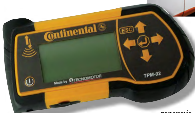
Przenośny komputer Continental skraca zdecydowanie czas kontroli ciśnienia i temperatury w kołach, zapewniając przy tym dużą wygodę.
