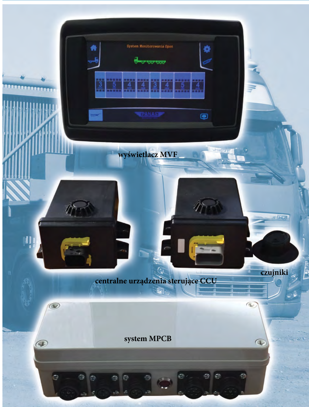
Różnice w ilości osi, jak i kół spowodowały konieczność wprowadzenia standaryzacji ilości wykorzystywanych CCU (po 2 na moduł), co umożliwia stałe przepinanie wózków między sobą, jak i przenoszenie wyświetlacza MVF z pojazdu do pojazdu.
