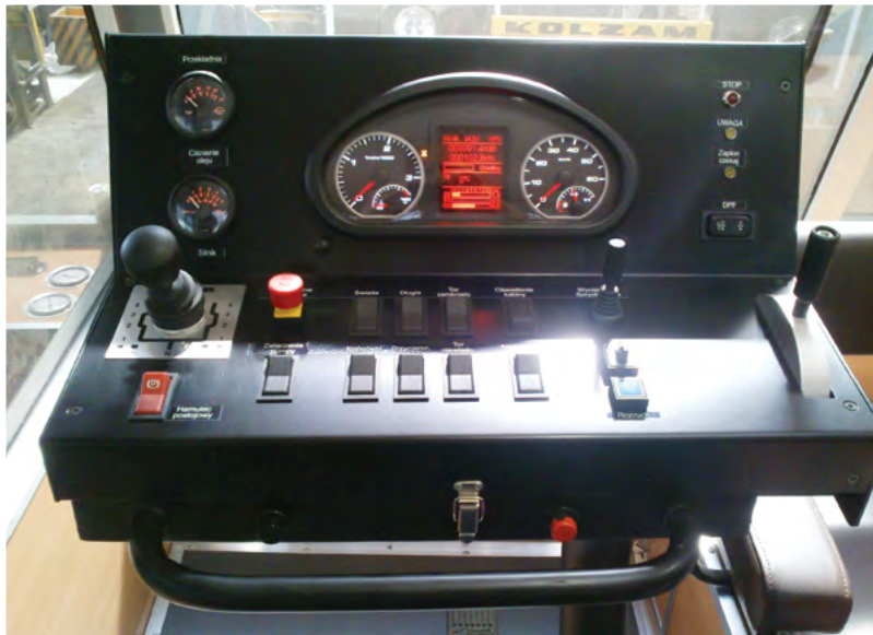
Do zmodernizowanych przez MAVEX – REKORD dwóch pojazdów dla Metra Warszawskiego zamontowaliśmy zespoloną deskę wskaźników Flexcluster wraz z naszym oprogramowaniem.
