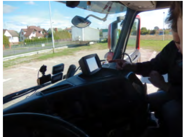
Kierowca ma świadomość, że jak tylko spojrzy na wyświetlacz, od razu wie, gdzie znajduje się koło, które dostarcza mu ewentualnych problemów, w którym jest ono wózku, na której osi?.
