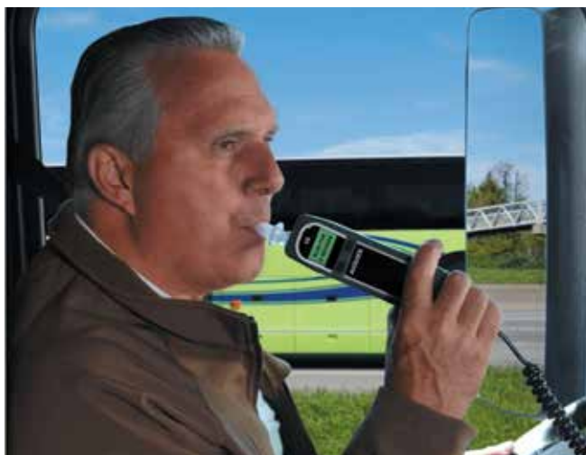
ALCOLOCK V3 wymusza na kierowcy sprawdzenie poziomu alkoholu we krwi przed każdorazowym uruchomieniem pojazdu lub w trakcie jazdy (w zależności od zaprogramowania).
