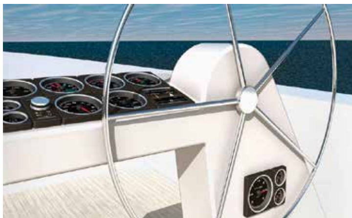
Zastosowanie wyświetlacza LCD oraz szeregu quasi analogowych wskaźników umożliwia optymalizację i hierarchizację otrzymywanych informacji.
