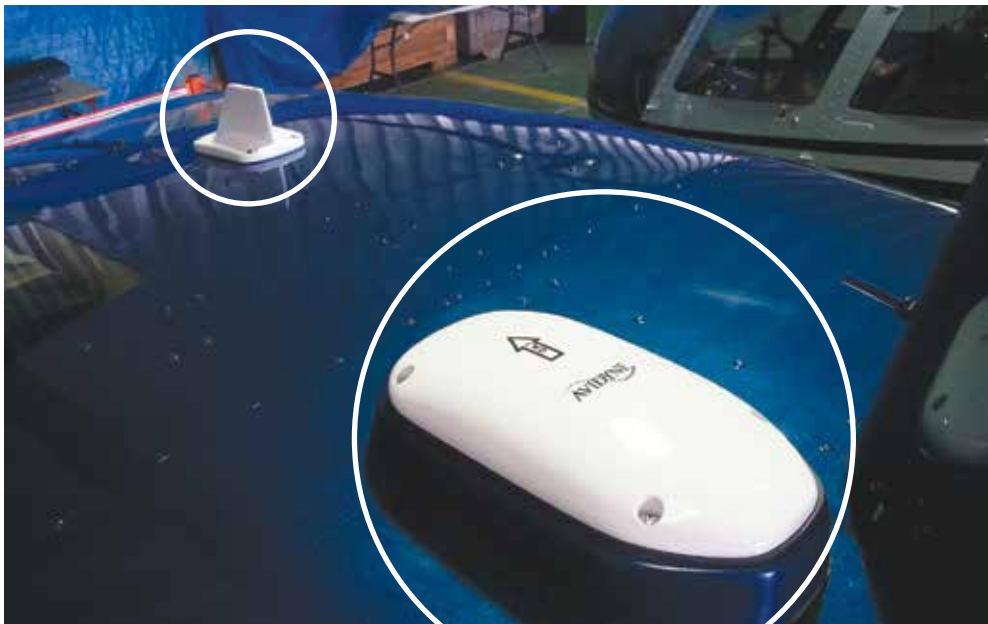
Zespół aktywnych anten „wypytyuje” i „nasłuchuje” odpowiedzi transponderów innych użytkowników przestrzeni powietrznej.
