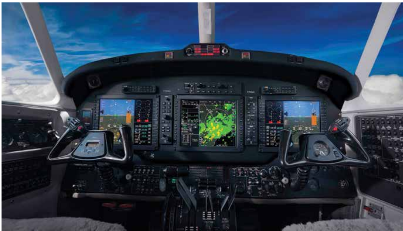
System pokładowy AeroVue™ łączy w sobie system zarządzania lotem, funkcję autopilota, widok syntetyczny SmartView™ i funkcjonalność INAV™ z kartami elektronicznymi wyświetlanymi na trzech, dużych 12" nowoczesnych wyświetlaczach LCD.
