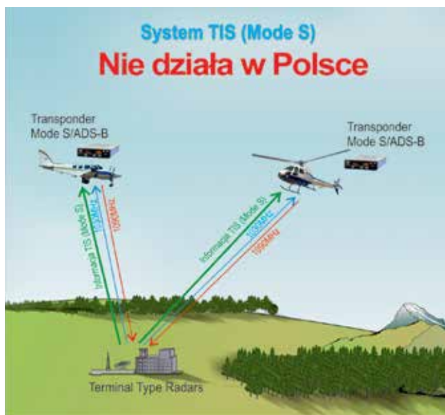
System antykolizyjny TIS bazuje na nadajnikach naziemnych Terminal Type Radars, których w Polsce po prostu nie ma, więc nie ma sensu kupować transponderów „S” z rozszerzeniem ADS-B.
