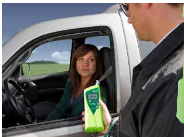
Ręczny analizator alkoholu w wydychanym powietrzu, działający na zasadzie absorpcji podczerwieni to idealny instrument do egzekwowania prawa na drogach.
