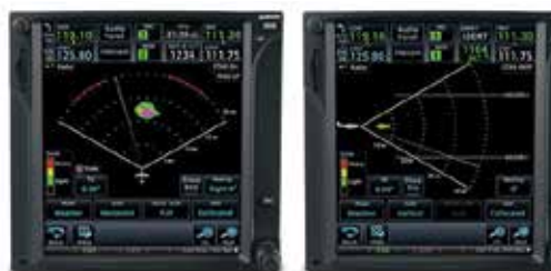
Dzięki zastosowaniu nadajnika półprzewodnikowego, GWX 70 to najnowsza i najbardziej niezawodna technologia pokładowych radarów pogodowych.
