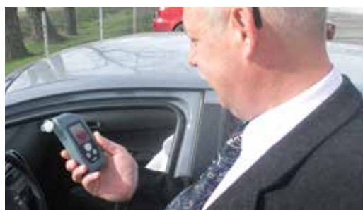
Analizator wyposażony jest w pamięć, w której zapisanych jest do 10. ostatnich pomiarów,
