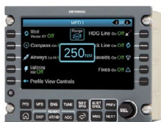
Zintegrowany system pokładowy InSight ma wbudowany widok syntetyczny, zawierający zaawansowaną możliwość mapowania, karty elektroniczne, sterowanie urządzeniami radiowymi oraz informację pogodową.
