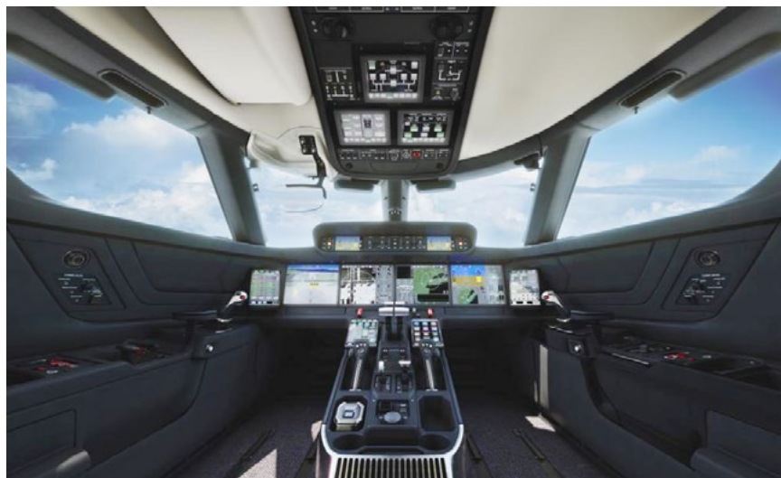
Nowe samoloty firmy Gulfstream Aerospace Corporation: G500 i 600 zostaną wyposażone w innowacyjny system pokładowy Gulfstream Symmetry™, firmy Honeywell, który będzie pierwszym systemem stosującym nową technologię ekranów dotykowych Honeywella.
