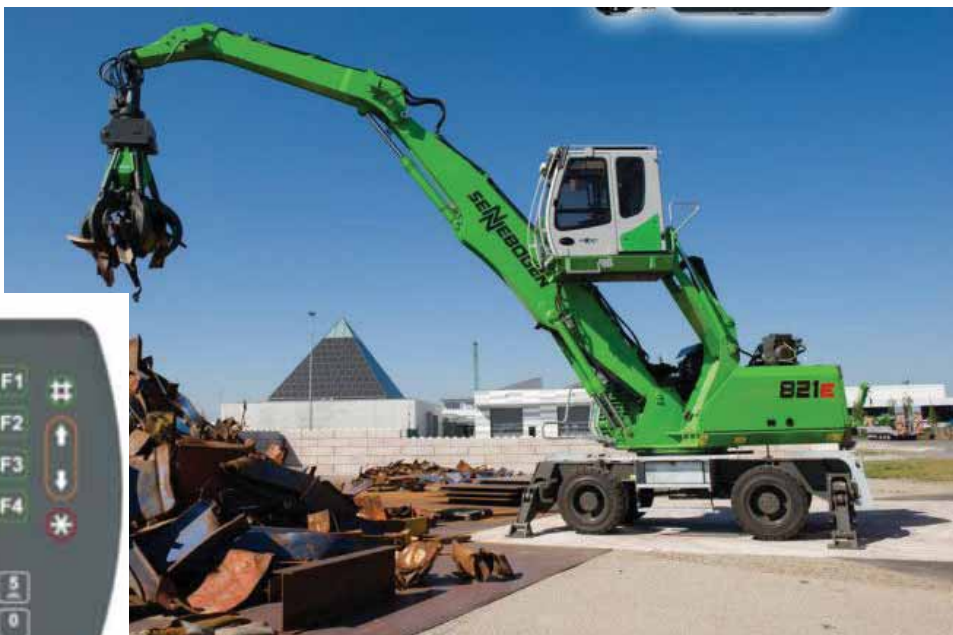
System ważenia pozwala na prawidłowy załadunek pojazdu, co chroni przed nadmiernym przeładowaniem - na wyświetlaczu widoczne są: bieżąca waga w chwytaku, całkowita - do tej pory załadowana oraz ilość załadowanych ładunków.
