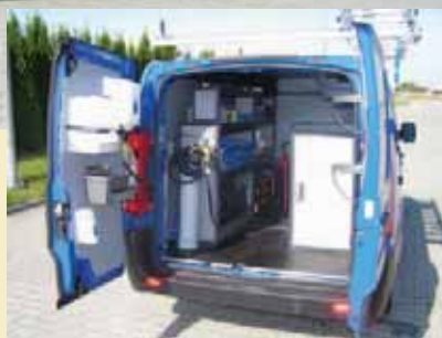
Wszystkie Fiaty Scudo posiadają agregat prądowórczy, prądnice 230 V, uchwyt na laptopa, półki na dokumentację, oświetlenie LEDowe, koguta dachowego, uchwyt na kaski ochronne, a także kącik sanitarny do umycia rąk i twarzy.
