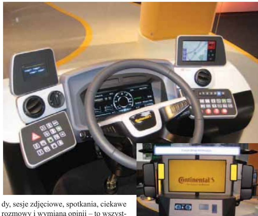
Na IAA po raz pierwszy zaprezentowano najnowsze miejsce pracy kierowcy – FAP mDWP z nowym, bardziej kolorowym i posiadającym wyższą rozdzielczość wyświetlaczem MVP 12.
