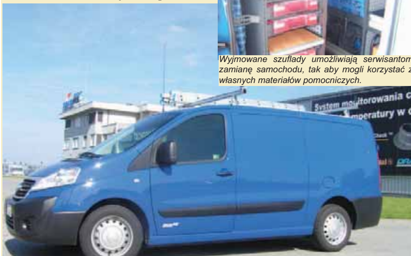
Wszystkie Fiaty Scudo posiadają agregat prądowórczy, prądnice 230 V, uchwyt na laptopa, półki na dokumentację, oświetlenie LEDowe, koguta dachowego, uchwyt na kaski ochronne, a także kącik sanitarny do umycia rąk i twarzy.
