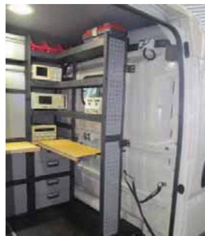
W mobilnym laboratorium znajduje się podręczny magazynek na części do napraw i instalacji oraz osobne regały/półki na elementy zdemontowane ze statku powietrznego na potrzeby obsługi, elementy/urządzenia sprawne, urządzenia oczekujące na obsługę, niesprawne i złomowane.
