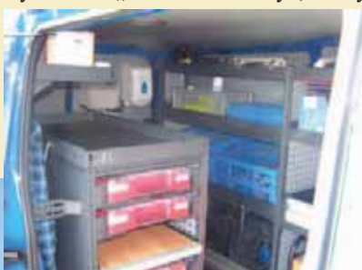
Wyjmowane szuflady umożliwiają serwisantom zmianę samochodu, tak aby mogli korzystać z własnych materiałów pomocniczych.
