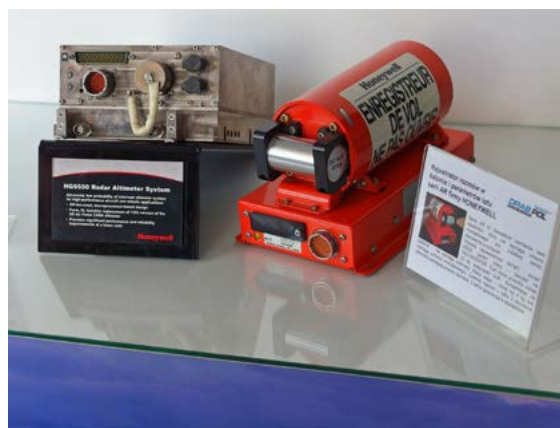
Z produktów firmy Honeywell uwagę zwracały systemy rejestrowania rozmów w kabinie i parametrów lotu oraz radiowysokościomierz HG9550.
