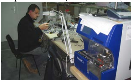
Nasza Organizacja PART 145 dysponuje m.in. maszyną do znakowania wiązek przewodów. Brak takiego oznaczenia wiązek w dalszej konsekwencji prowadzi do m. in. chaosu dokumentacyjnego.
