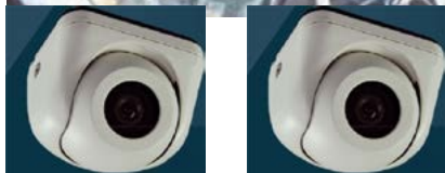
Widok z kamer wewnątrz pojazdu daje kierowcy możliwość kontroli zachowań pasażerów podczas podróży. Obraz z tych kamer jest też nagrywany przez rejestrator.
