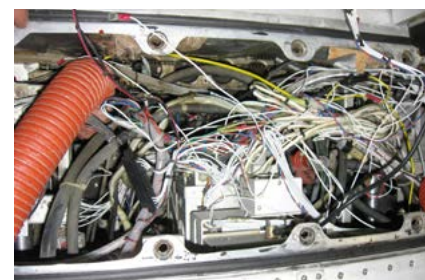
Tak wygląda instalacja wykonana przez tzw. „fachowca” od awioniki.
