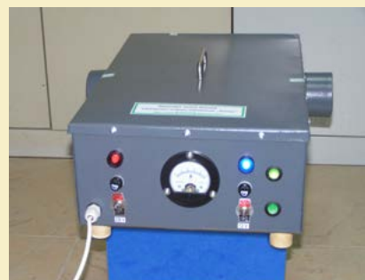
Nasze serwisy wyposażone są w mobilne urządzenia do odgrzybiania klimatyzacji.
