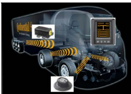
System CPC ściśle współpracuje z systemem FM, dzięki czemu zarządzający flotą, czy dyspozytor mają pełną informację o stanie swoich pojazdów i w razie wystąpienia awarii ogumienia dostają alarm i mogą natychmiast podjąć odpowiednie kroki w celu usunięcia usterek.
