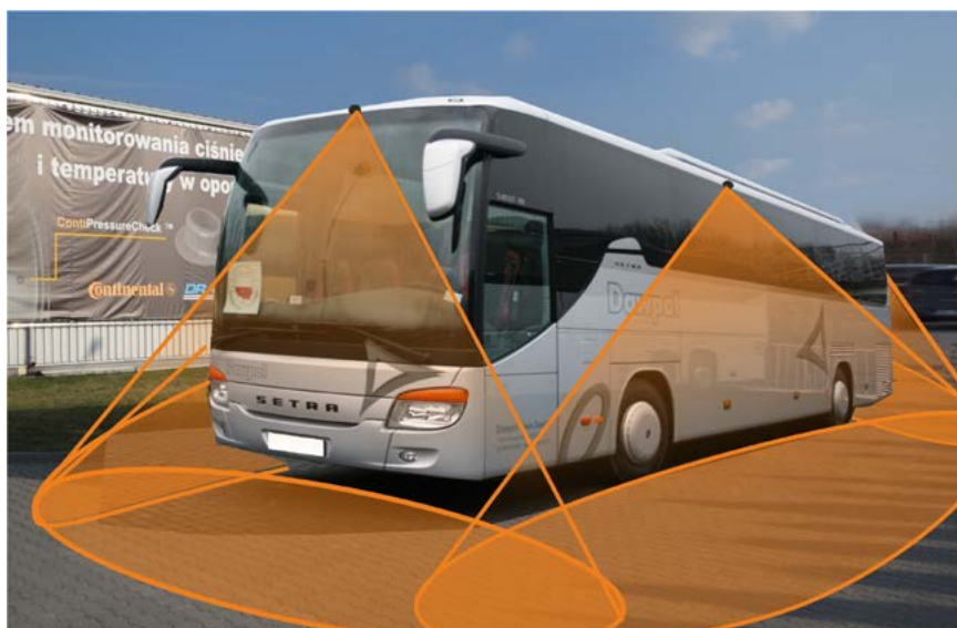
Bezpieczeństwo podróżowania zwiększa m.in. system pełnego podglądu wokół pojazdu ProViu, zainstalowany w autobusie turystycznym marki SETRA, należącym do firmy Dawpol.
