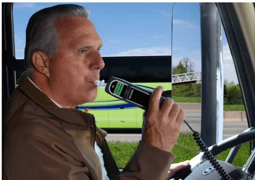
System alcolock wymusza na kierowcy sprawdzenie poziomu alkoholu we krwi przed każdorazowym uruchomieniem pojazdu lub w trakcie jazdy w zależności od zaprogramowanych ustawień.
