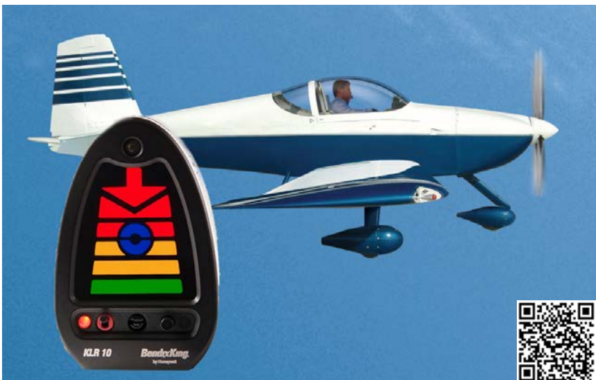
Czytelny wskaźnik szybko informuje (wizualnie i dźwiękowo), czy samolot leci na „bezpiecznym” kącie natarcia (zielone pole), czy kąt natarcia znacznie wzrasta (okolice 10 stopni, pole żółte), czy też jest już w niebezpiecznym zakresie (pole czerwone).
