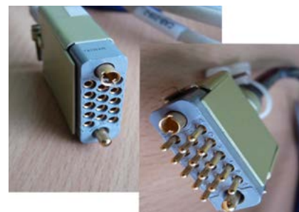
Powodem usterki autopilota była zamiana miejscami kołków pozycjonujących, a co za tym idzie odwrotne wpięcie złącza, przez co serwo mechanizm nie działał na samolocie.
