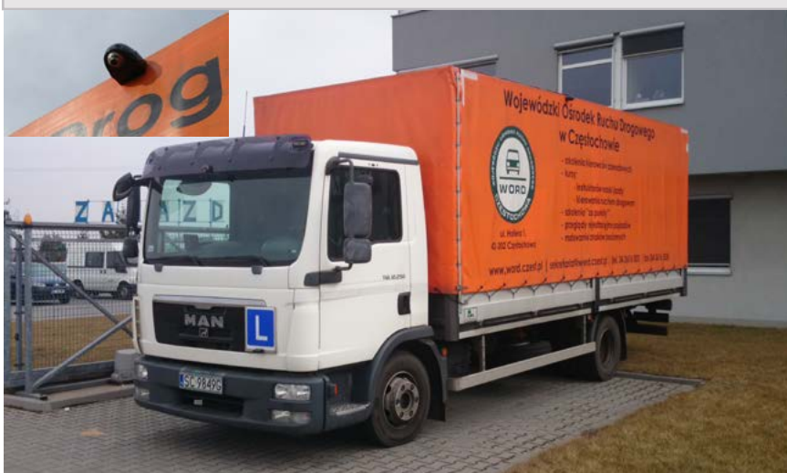
System ProViu umożliwia obserwację pojazdu i obszaru wokół pojazdu z góry w taki sposób, jakby widziany obraz rejestrowany był z kamery umieszczonej nad pojazdem. Istnieje przy tym możliwość skonfigurowania dodatkowej rejestracji pojedynczej kamery.
