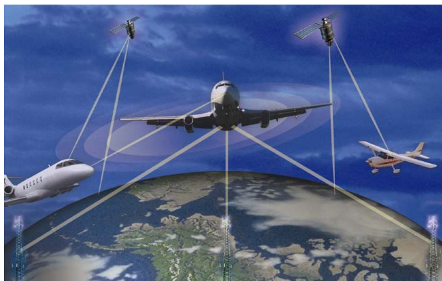
Już za kilka lat w system automatycznego raportowania swojej pozycji z wysoką dokładnością, innym uczestnikom ruchu lotniczego, a także służbom naziemnym (ADS-B) będą musiały być wyposażone wszystkie statki powietrzne poruszające się w przestrzeni kontrolowanej.
