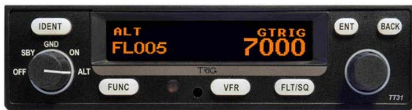
Nowy transponder TRIG wyróżniają m.in. łatwiejsza instalacja, czy szersza kompatybilność z awioniką.
