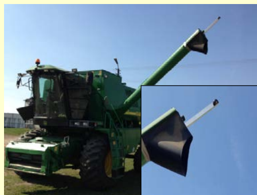
Dzięki piątej kamerze umieszczonej na rurze do kipowania zboża operator ma stały nadzór nad wysypywaniem zboża na przyczepę.
