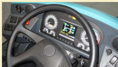
Informacje o ciśnieniu i temperaturze w oponach mogą pojawić się na wyświetlaczu DMUX (na zdj. - w pojeździe AMZ Kutno).
