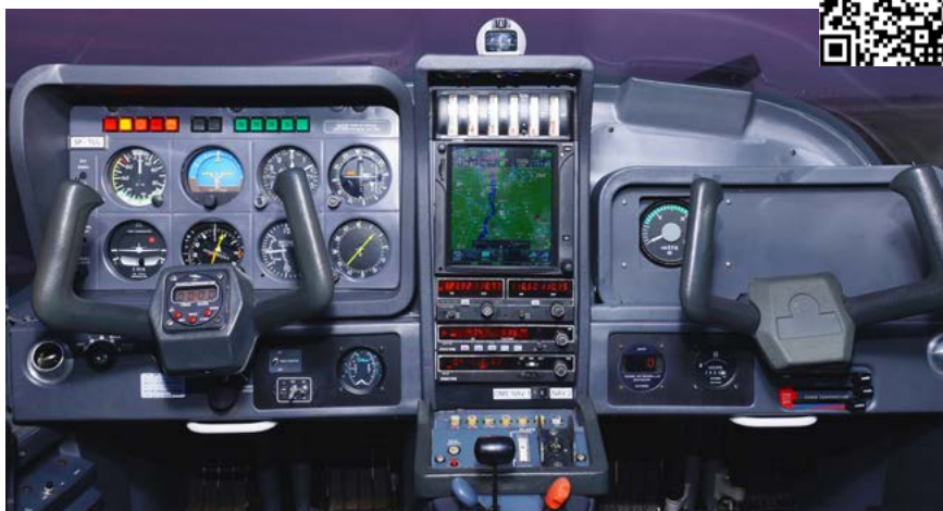
Modernizacja Socat polegała na wymianie przestarzałych urządzeń nawigacyjnych i łączności na nowoczesne wyposażenie, w tym systemy NAV/COM Garmin GTN 750 wraz z transponderami Garmin GTX 33 i audiopanelami Garmin GMA 35, a także wskaźnikiem HSI Bendix King KI-525.
