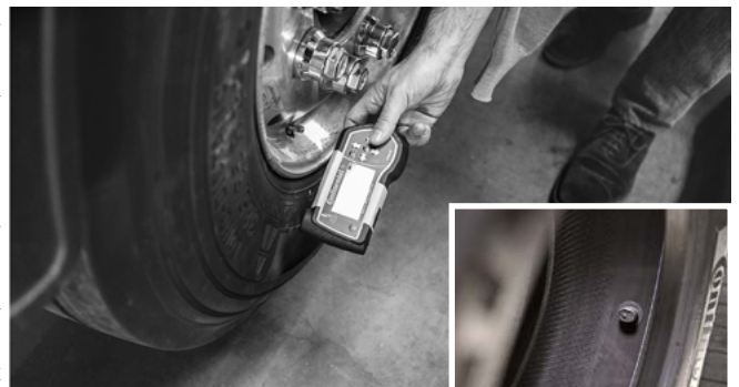
W jednym module, zamkniętym w gumowym pojemniku, przyklejanym do wewnętrznej powierzchni opony zintegrowano czujniki, system komunikacji i przetwarzanie danych.
