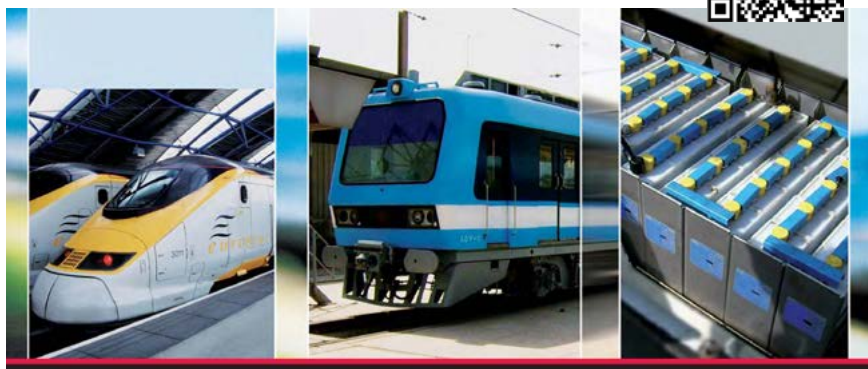
Znakomita odporność pod względem elektrycznym i wytrzymałość na naprężenia mechaniczne decydują m.in. o stosowaniu baterii Ni-Cd rail w warunkach ekstremalnych.
