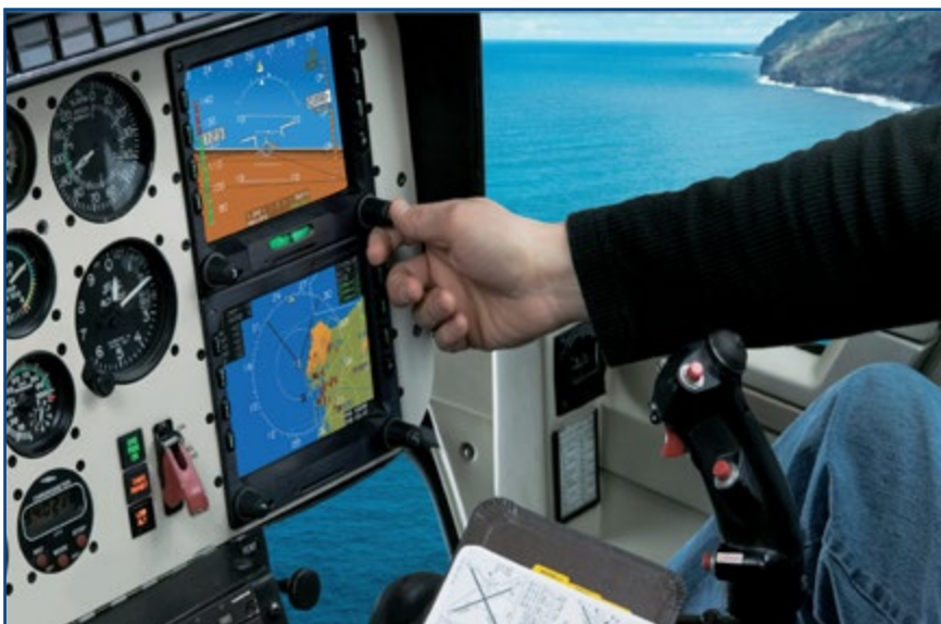
Autopilot systemu HeliSAS obsługuje m.in. tryby kontroli kierunku, wysokości, nawigacji z pokładowego systemu NAV lub GPS.
