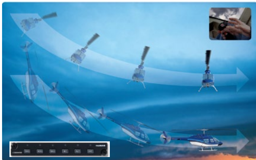
Dwuosioowy autopilot HeliSAS zapewnia stabilizację położenia w przestrzeni.
