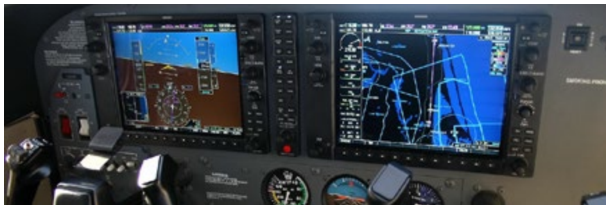
W ostatnim czasie Garmin wprowadził na rynek w pełni zintegrowany, „szklany” kokpit – G1000 do samolotów, takich jak Cessna, Piper czy Zlin.
