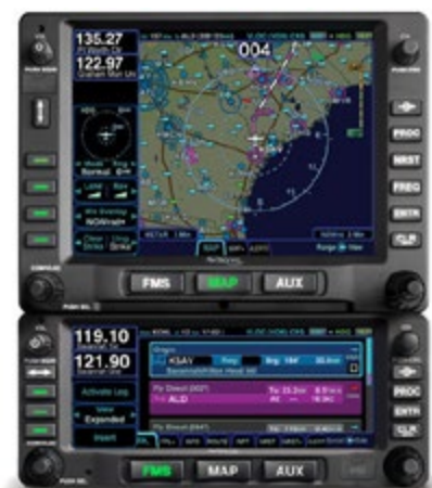
Urządzenie NAV/COM/GPS IFD440/550 Avidyne łączy w sobie dwie filozofie: „klasyczną” klawiszową i dotykową.
