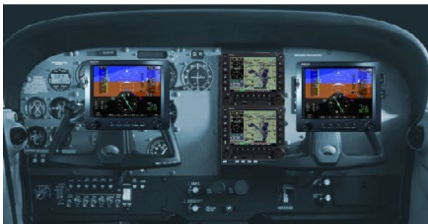
Najnowsza propozycja Bendix/Kinga to seria APEX EGDE, czyli zobrazowanie klasycznych przyrządów pilotażowych na dużym wyświetlaczu typu PFD, KFD 840 oraz wyświetlaczu wielofunkcyjnym MFD.
