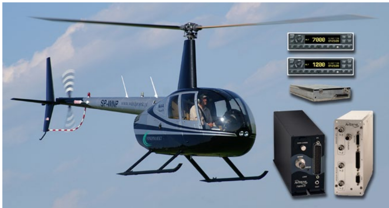
Modernizacja awioniki na R 44 obejmuje instalację systemu antykolizyjnego TAS 615 Avidyne, systemu Stormscope TWX 670 Avidyne oraz transpondera Garmin.
