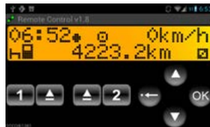
Przegląd aktualnego czasu pracy kierowcy (aplikacja VDO Driver obrazująca funkcje VDO Counter).
