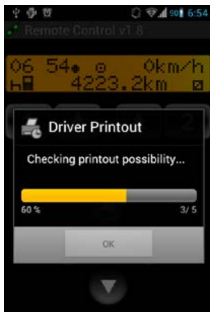
DTCO SmartLink pozwala na robienie wydruków bez potrzeby dotykania tachografu.
