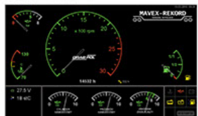
Dla mikrobuse szynowego firmy MAVEX opracowaliśmy oprogramowanie, odczytujące z sieci CAN informacje, przedstawiane w postaci analogowych wskaźników ViewGate.
