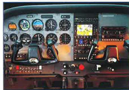
Klasyczna awionika marki BendixKing" dominuje m.in. w popularnym samolocie Cessna 172
