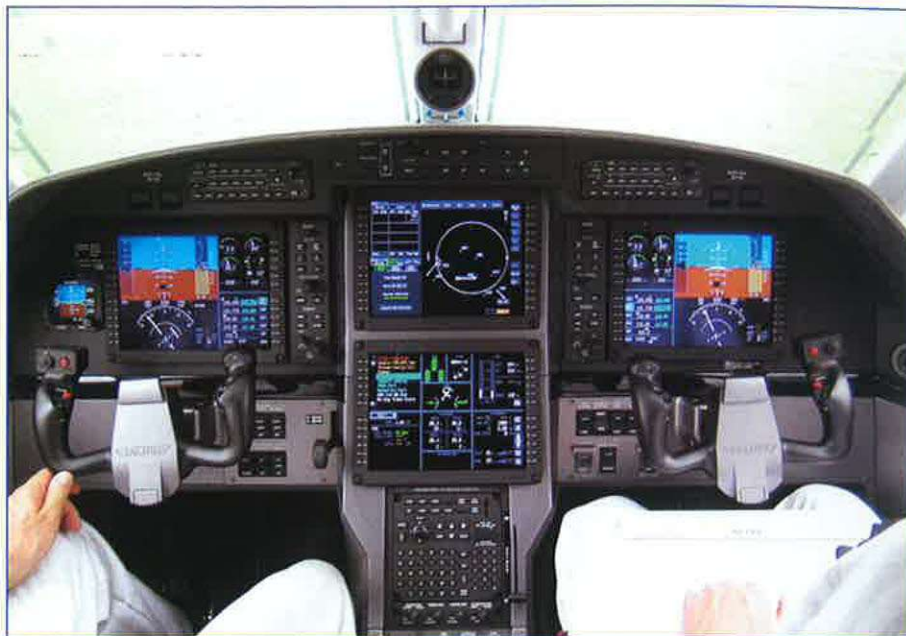
W kabine pilotów samolotu Pilatus PC-12 zastosowano system awioniczny marki Honeywell
