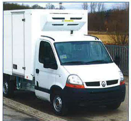
Urządzenie chłodnicze TK4050 przeznaczone do transportu produktów świeżych i mrożonych montowane jest na pojazdach typu furgon, czy pojazdach kontenerowych
