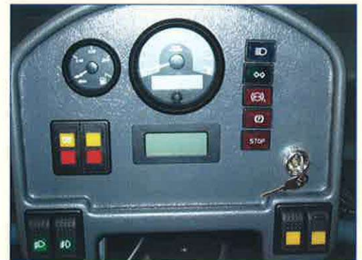
Do seryjnej produkcji równiarek RD 165 firmy MISTA wprowadzono urządzenie CANCockpit do monitoringu pracy silnika
