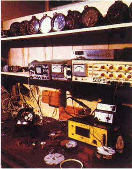
Pierwsze stanowisko do kontroli i napraw tachografów
