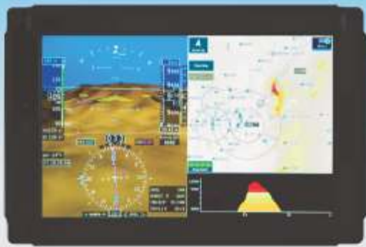
AeroVue Touch PFD display.
